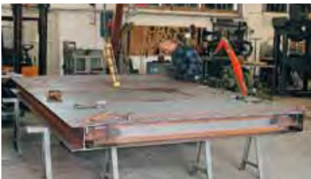
Herstellung einer Stahl-Plattformwaage
